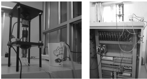
图 9 音圈促动器、液冷循环系统和控制柜
