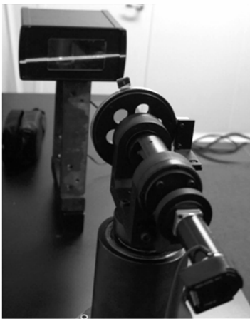
图 7 角度检测及误差标定试验装置图
