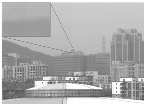
图 2 多输出 CCD 图像接缝示意图
