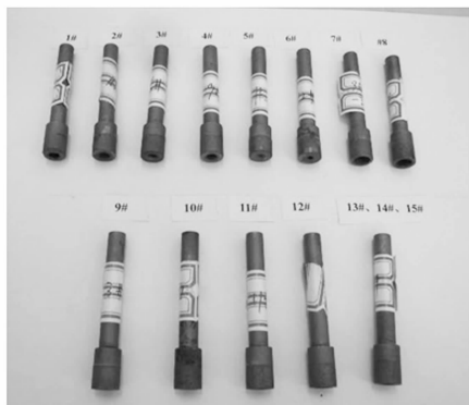
图 1 实验用超声振动磨具
