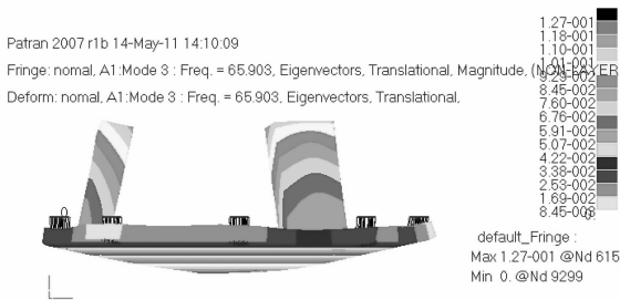
图 6 仪器安装板采用金属橡胶减振器减振时的一阶模态 Fig. 6 First mode of instrument installation plate with metal-rubber vibration absorber
