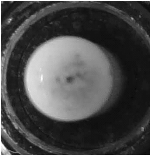
图2 沉积石墨烯后的氧化锆光纤插芯端面图
