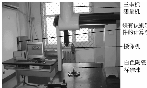
图 2 零件位姿视觉识别系统组成
