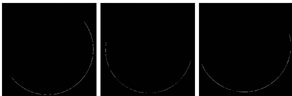
图 3 行星图像有效边缘粗检测结果
