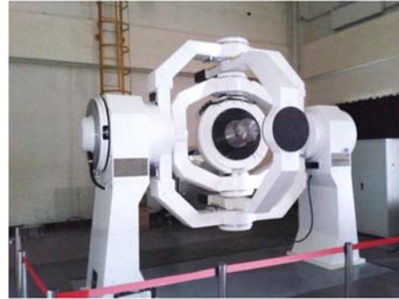
图 8 五轴飞行模拟转台 Fig. 8 Five axis flight simulator
