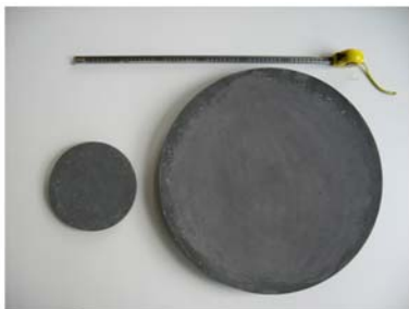
图 3 \Phi 200 mm 和 \Phi 500 mm 超轻量化 SiC 反射镜镜坯 Fig. 3 \Phi 200 mm 和 \Phi 500 mm ultra-lightweight SiC mirrors
