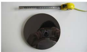
图 6 \Phi 200 \text{ mm} 超轻量化 SiC 反射镜的光学加工镜面 Fig. 6 Surface of \Phi 200 \text{ mm} ultra-lightweight SiC mirror after grinding
