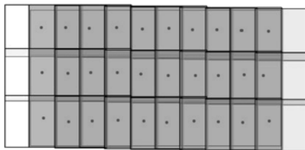
图 2 匹配中心点参与区域网平差示意图
