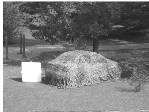
图 1 利用伪装网对合作目标进行伪装
