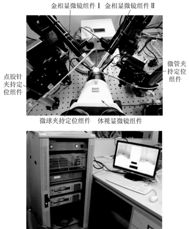
图 6 微管微球装配点胶系统
