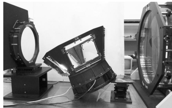
图 8 滤光片面形精度测试
