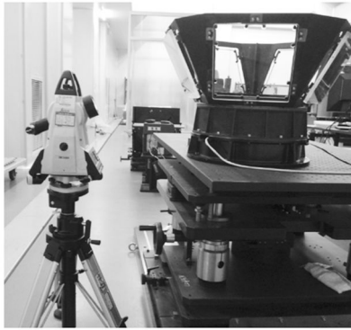
图 9 滤光轮驱动机构精度测试
