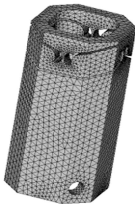
图 7 柔性支撑平台有限元仿真模型
