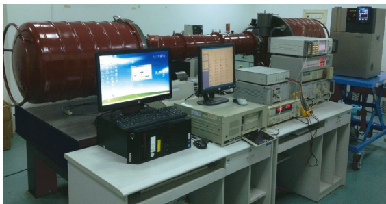
图 2 低温状态下材料法向发射率测量装置实物图
