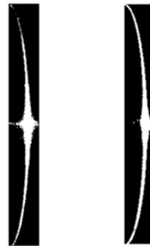
图 10 大津法二值图(左)和移动阈值法二值图(右)
