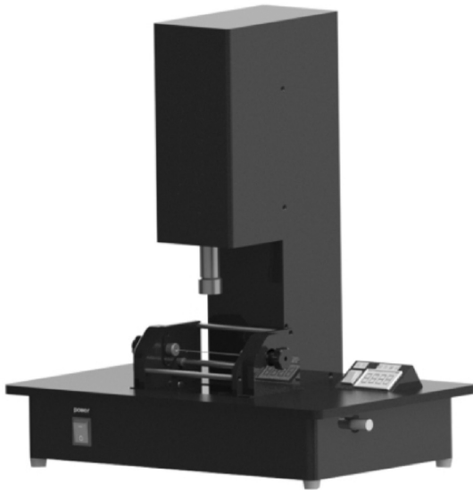
图 6 切割钢丝自动测量仪实物图 Fig. 6 Picture of automatic measuring instrument
