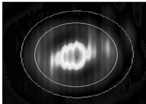
图 4 角锥 1# 的实测远场衍射图样(白圈角直径 22",红圈角直径 30") Fig. 4 FFDP of CCR 1 # (white ring for 22", red ring for 30")
