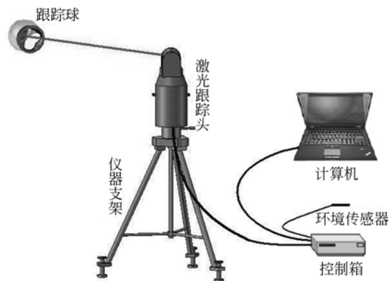
图 1 激光跟踪仪系统组成示意图
