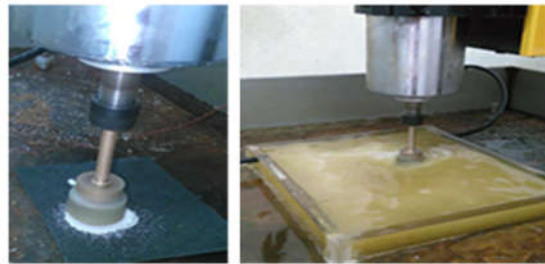
(a)磨具在线修整 (b)加工过程 (a) In-process dressing (b) Processing 图 5 试验实物图
