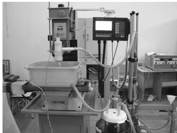
图 2 射流电沉积实验系统
