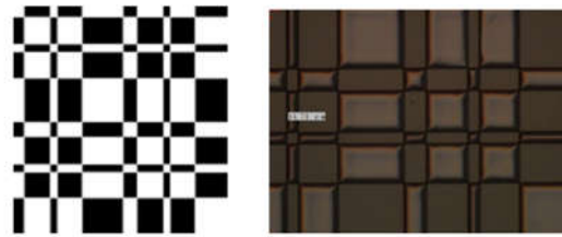
图 6 8×8 达曼光栅单周期设计图(左)及光刻显微照片(右)
