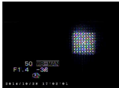
图 16 达曼光栅激光分束效果图
