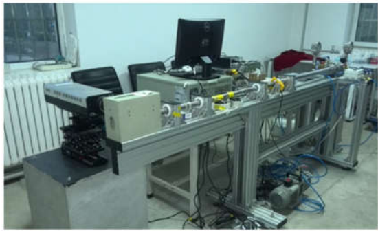
图 6 双弹头 Hopkinson 杆校准装置 Fig. 6 Calibration device of Dual Warhead Hopkinson Bar
