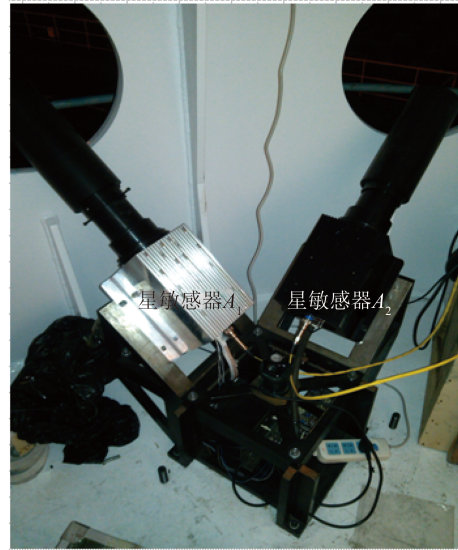
图 5 船载星敏器安装角标定试验
