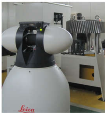
图 7 特大型齿轮激光跟踪在位测量系统
