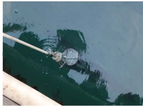
图 5 海水下行辐照度测量
