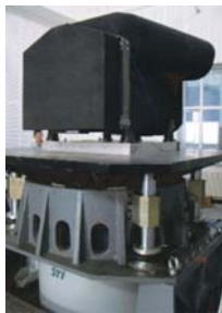
图 14 大口径空间相机结构样机振动试验
