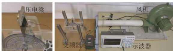
图 6 压电风能捕获器及测试系统
