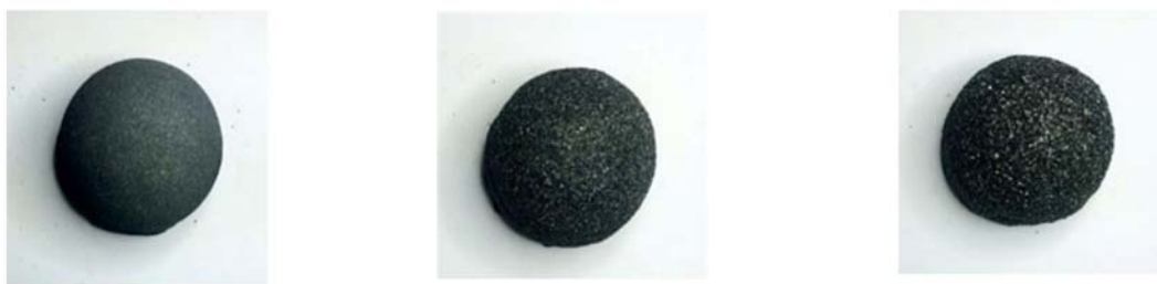
(a) 第一黏磨层(180 #) (b) 第二黏磨层(+120 #) (c) 第三黏磨层(+80 #) (a) First abrasive layer(180 #) (b) Second abrasive layer(+120 #) (c) Third abrasive layer(+80 #)
