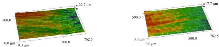
(d)手动更换3种不同目数气压砂轮加工
