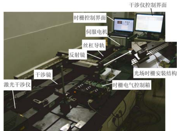
图 6 单栅式时栅测量实验平台
