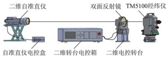
图 5 二维自准直仪标定
