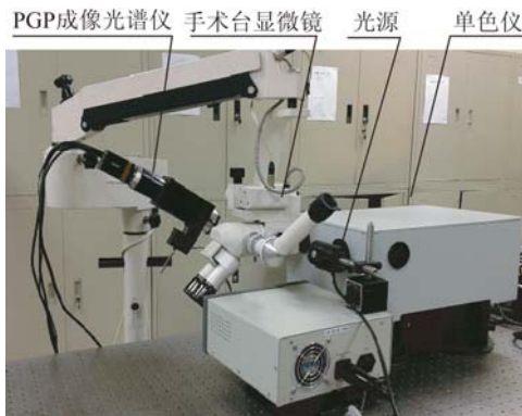
图 4 医用显微光谱仪定标装置实物图
