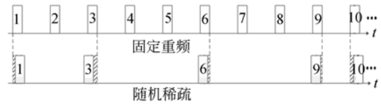
图 3 随机脉冲发射时刻示意图
