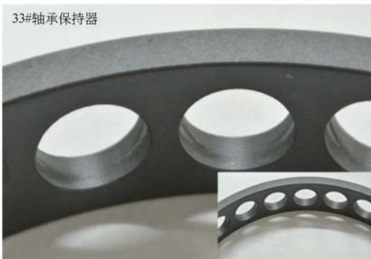
图 4 真空寿命试验后轴承保持架 Fig. 4 Bearing retainer after vacuum life test
