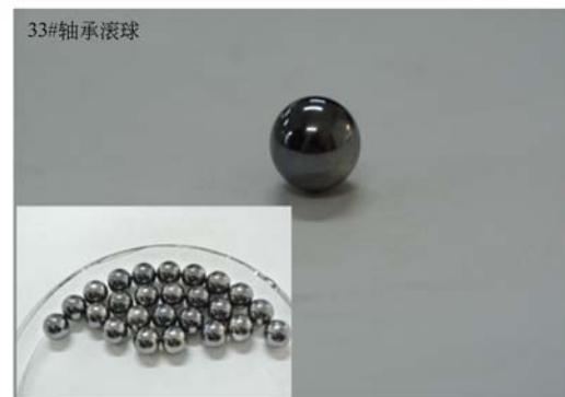
图 3 真空寿命试验后轴承钢球
