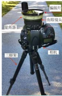
图 5 全天域大气偏振模式成像装置
