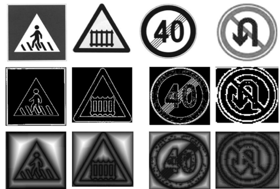
图 7 不同标志的边缘图像及类欧氏距离变换效果 Fig. 7 Edge images and class Euclidean distance transformation of different traffic signs
