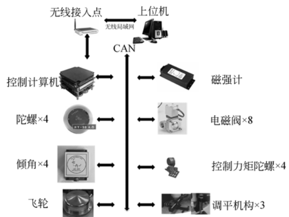
图 6 控制计算机及通信方案原理图 Fig. 6 Schematic diagram of control computer and communication scheme
