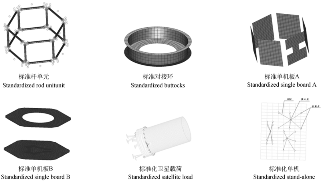
图 10 某卫星平台结构标准化组成单元有限元模型 Fig. 10 A kind of finite element model of satellite structure unit
