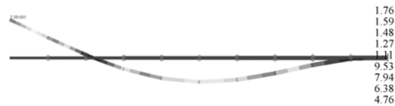
图 8 横向二阶弯曲振型
