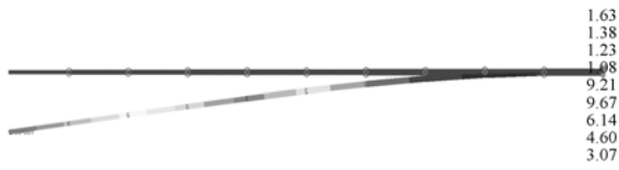
图 7 横向一阶弯曲振型
