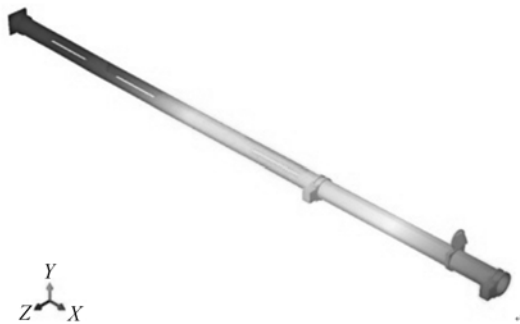
图 6 主星伸杆展开状态的一阶振型图
