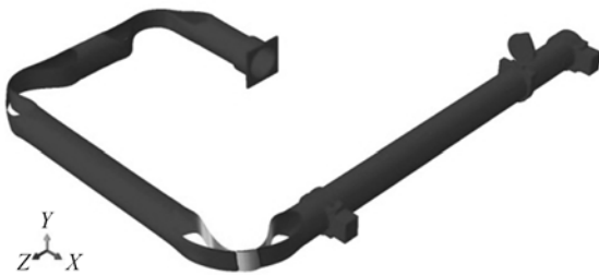
图 5 主星伸杆收拢状态的一阶振型图
