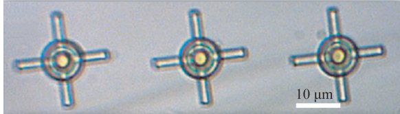
(c)四叶轮微转子结构在乙醇溶液中的光学显微镜图
