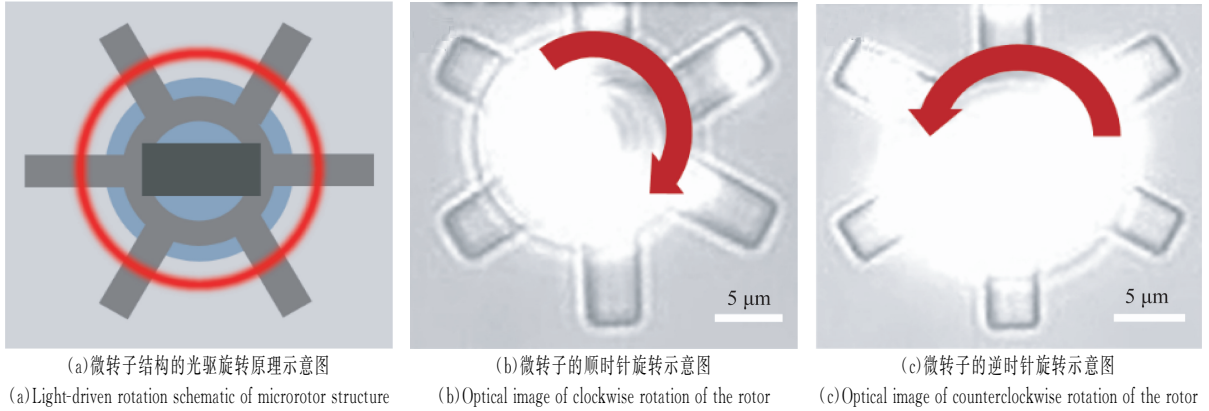
图 5 微转子光驱动
