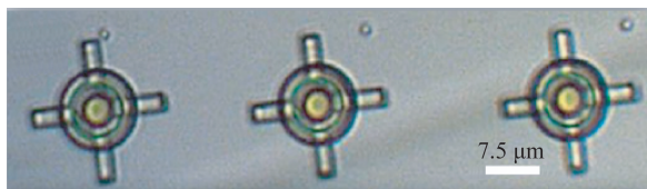
(a)四叶轮微转子结构的光学显微镜图
