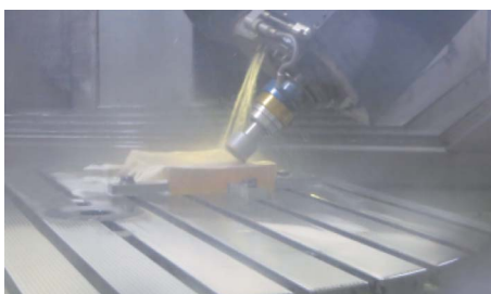
图 5 自由曲面镜铣磨加工过程
