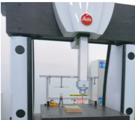
图 6 自由曲面镜三坐标面形检测过程
