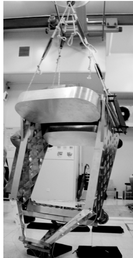
图 8 结构样机自由模态测试条件
