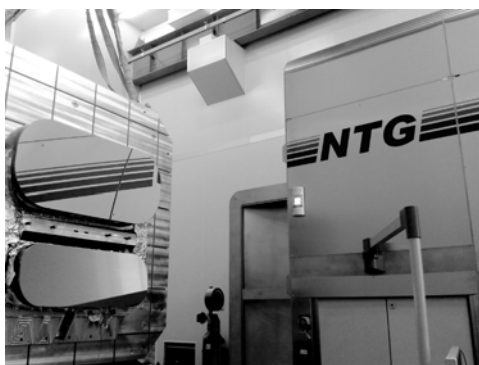
图 5 主三镜离子束加工
