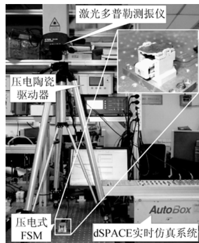
图 4 压电式 FSM 及其线性化控制器的快速原型系统和 Bouc-Wen 算子参数辨识实验装置实物图
