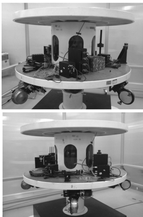
图 8 三轴气浮转台及星上设备模拟
