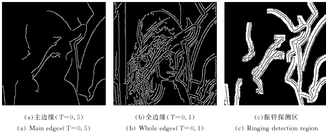
图 4 边缘提取与振铃探测区确定
