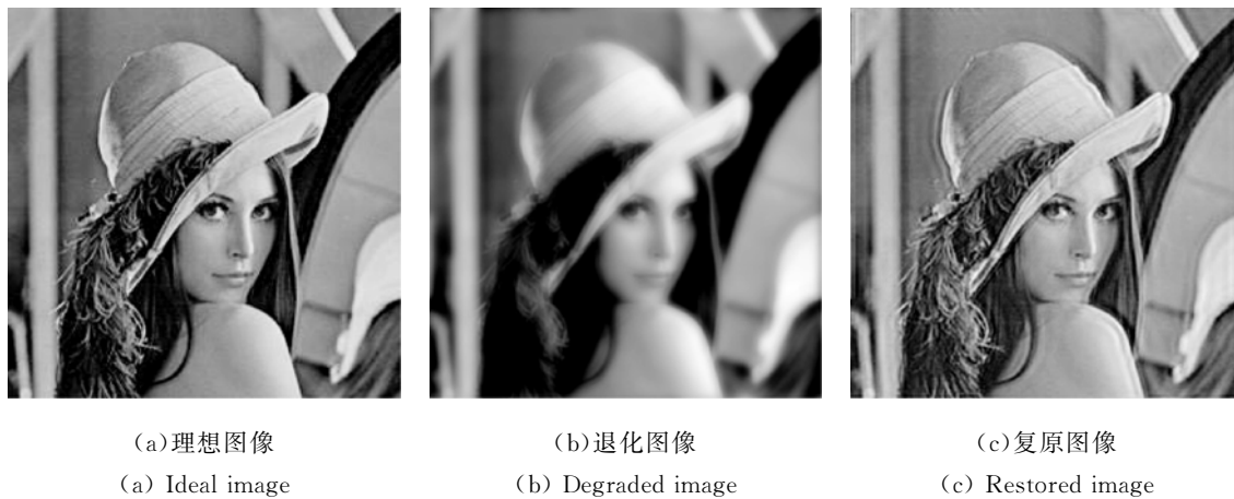
图 2 光学合成孔径成像仿真与复原结果
