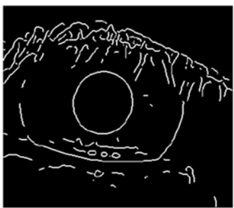
图 3 基于 Canny 算子的边缘图像 Fig. 3 Edge image based on Canny operator
