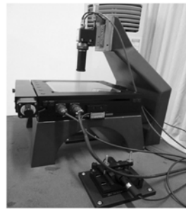
图 8 视觉检测系统
