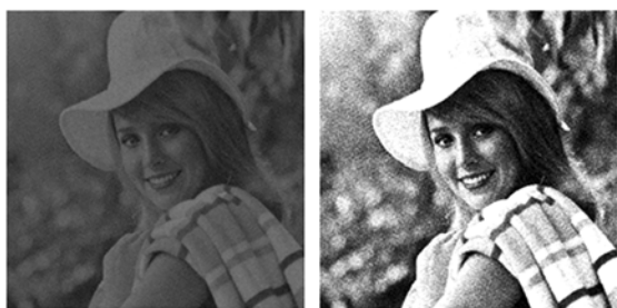
(a) 原图 (b) 直方图均衡化 (a) Original image (b) Histogram equalization
